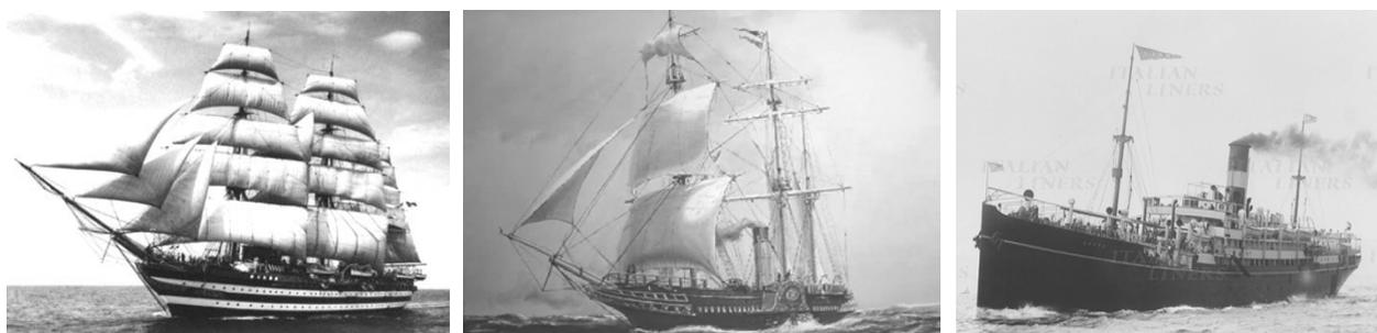
*Figura 1. Le navi del 1800, da sinistra una nave a vela, segue una a vapore e vela (per il timore di guasti meccanici o di esaurimento del carbone) ed infine solo a vapore con elica centrale.*
